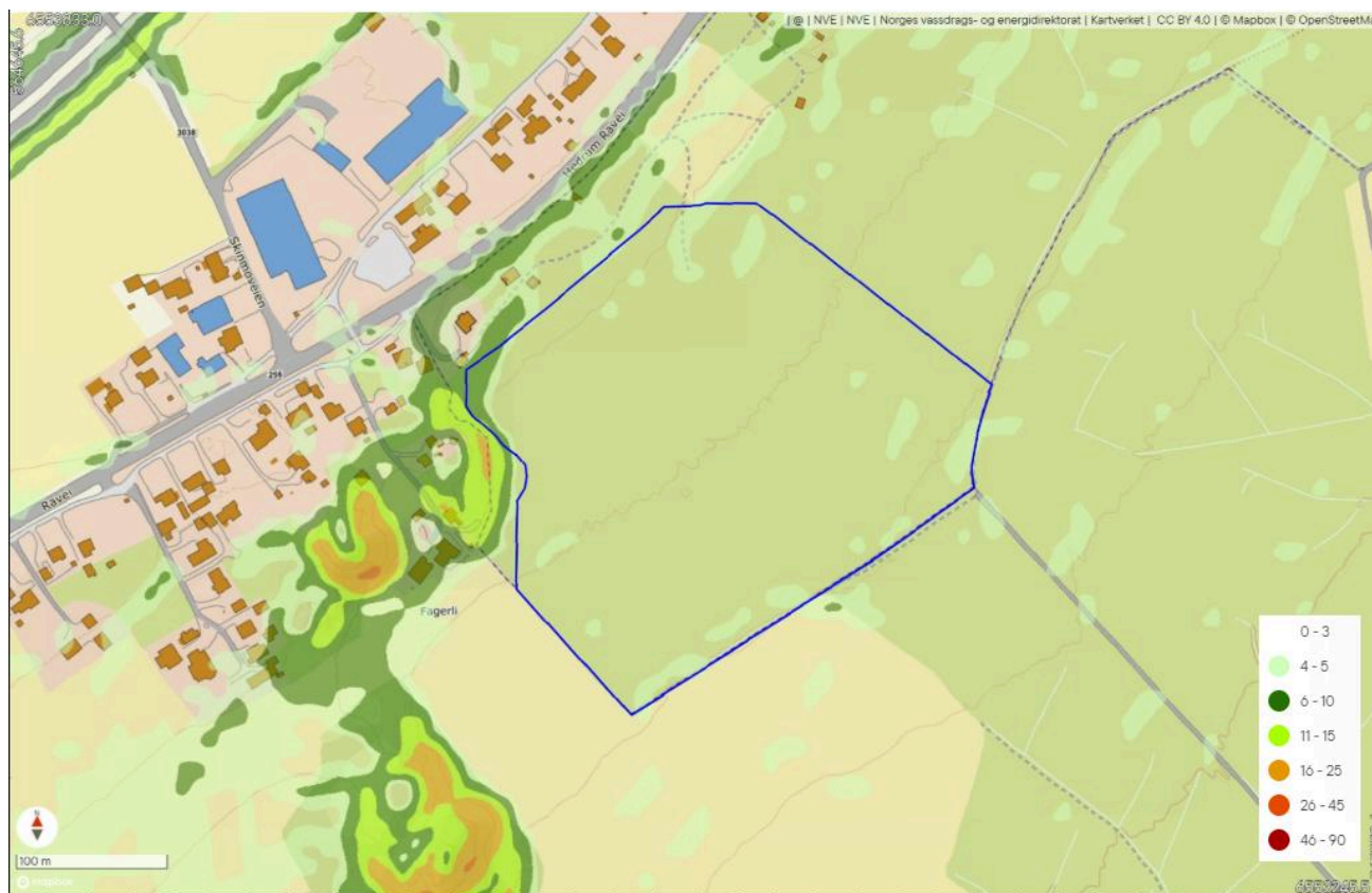
Figur 7 Oversikt over områder med helning over 4 grader. Planområdet er markert med blått omriss og
