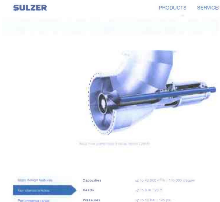
Figure 7-1 Typisk propeller pumpe med stor kapasitet, men liten løftehøyde
