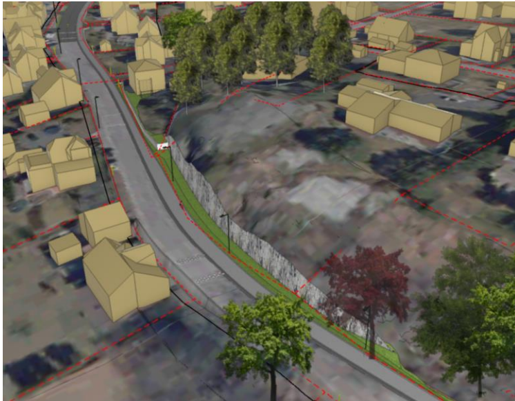
Figur 7. Bilde fra modell som viser skjæring. (Kilde: VFK og Asplan Viak AS)
