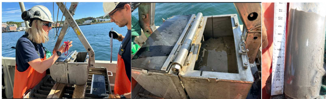
Figur 3-2 Sedimentprøvetaking ved bruk av Van Veen grabb fra fartøy Trygve Braarud.
