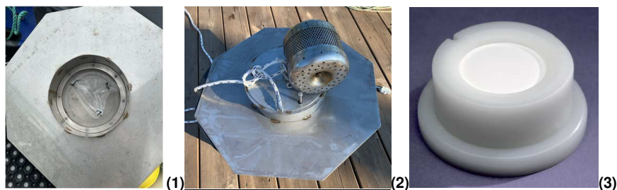
Figur 3-5 Passive prøvetakere. (1) og (2) Fluks kammer med SPMD membran direkte over havbunnen (NGI), (3) Fluks (3) DGT for analyse av metaller.
