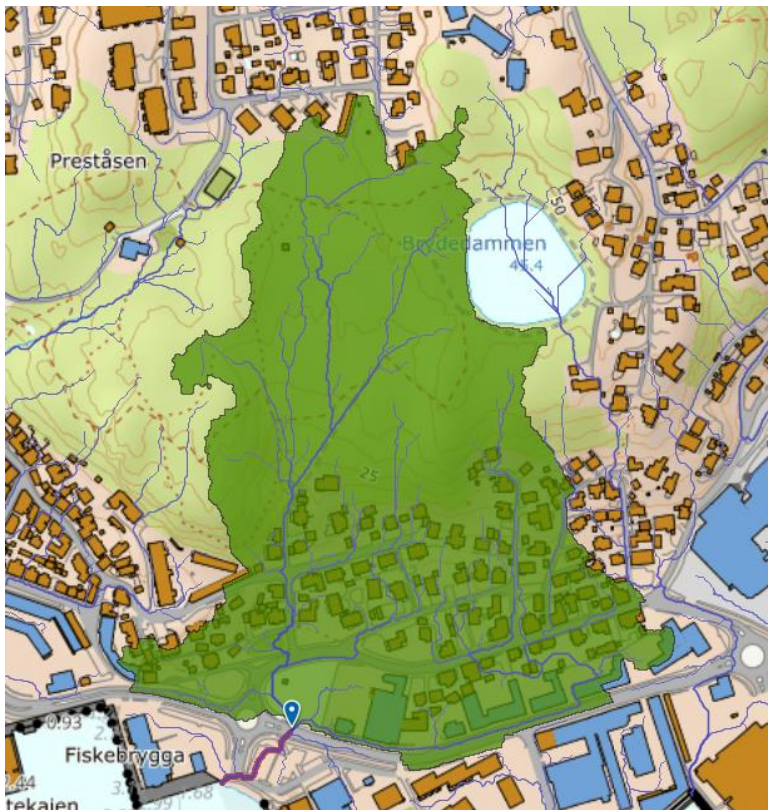
Figur 27: Nedbørsfelt bak en eventuell barriere.
