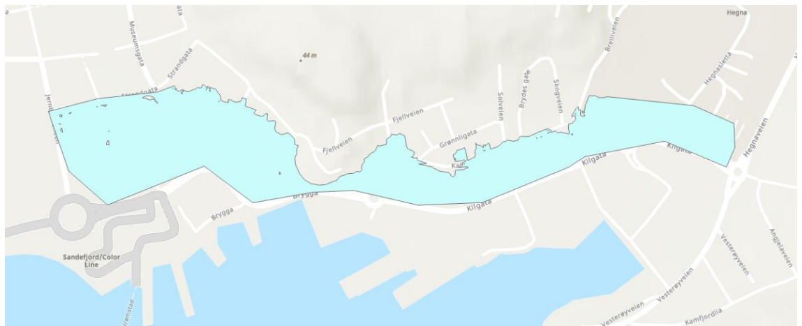
Figur 28: Det sammenhengende området under kote 2,04 bak flomvollen.
